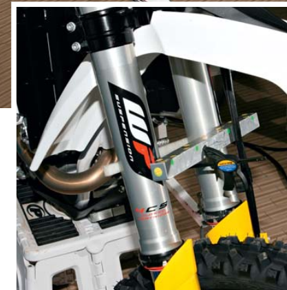
MISURE SOVRAPPONIBILI. Fatte salve le specificità delle sospensioni posteriori evidenziate nello schema, le KTM e Husqvarna enduro hanno dimensioni sovrapponibili. Il rilievo è stato effettuato con un banco GMD Computrack che usa un teodolite insieme a un software che elabora le letture ai due estremi; da qui i diagrammi della progressione e dei carichi molla della pagina accanto. Nel particolare, la curva di carico di un tampone.
